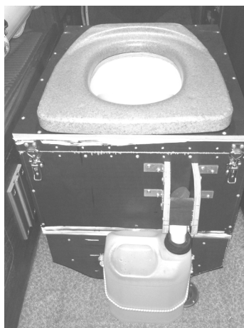
En tät plywood-stomme där sitsen är limmat till ett uppfälbart lock. Dunken lirkas lätt loss för tömning i land.
